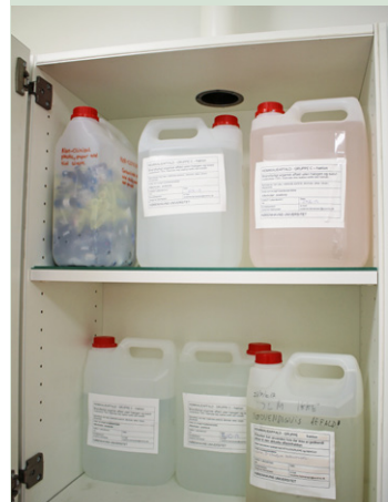
Ventileret opbevaring af dunke med kemikalieaffald
