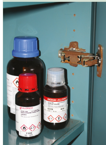
Stærkt ætsende kemikalier korroderer metalhængsler i opbevaringsskabe
