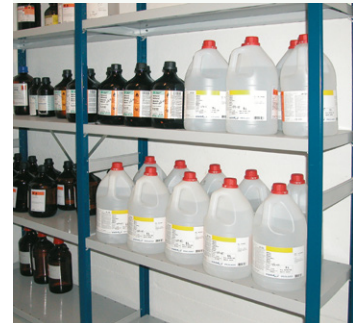
Ubrudte beholdere med brandfarlige væsker på åbne reoler. Når der er effektiv rumventilation, skal lageret ikke zoneklassificeres
