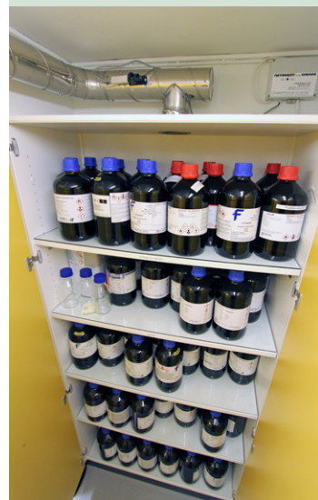
Kemikalieskab med overbelastede hylde. Specielt betænkeligt at glasflasker med opløsningsmidler er placeret højt
