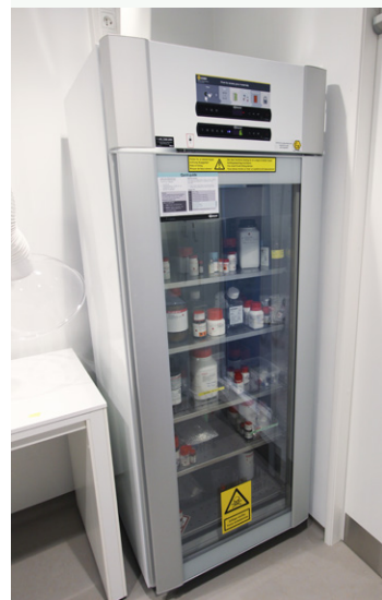
Billedet viser et køleskab med spjældfunktion, som kan tilkobles udsugningen. Den oprindelige CE-mærkning og ATEX-krav til zone 2 er stadig opfyldt. Den elektriske og mekaniske konstruktion opfylder kravene til zone 2 indvendigt og udvendigt, også når døren på køleskabet åbnes.
