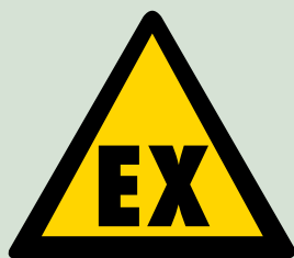
Skiltning for eksplosionsrisiko
