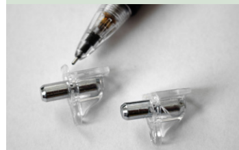
Dårlige hyldebærere var årsag til, at hylde med kemikalier faldt ned
