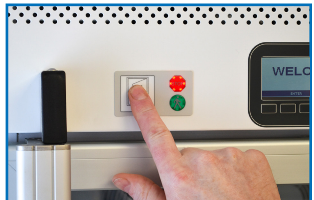
Åben og lukke panel for start af ventilering af køleskabet
