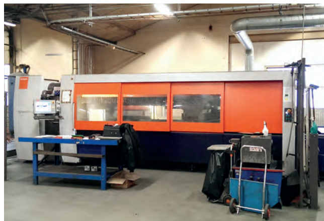
Eksempel på procesudsugning fra maskine uden supplerende rumudsugning (Laserskære ved Skandia Laser Teknik A/S).
