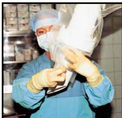
Slangeovertrækket samles om kildefilterets tilspidsede del med elastik og dobbelttæpe. Nu er punktsuget med FLEXODUCT® Kildefilter klar til brug.
